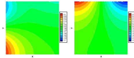
**Рис. 1.** Распределение давления (слева) и потенциала электрического поля (справа).
