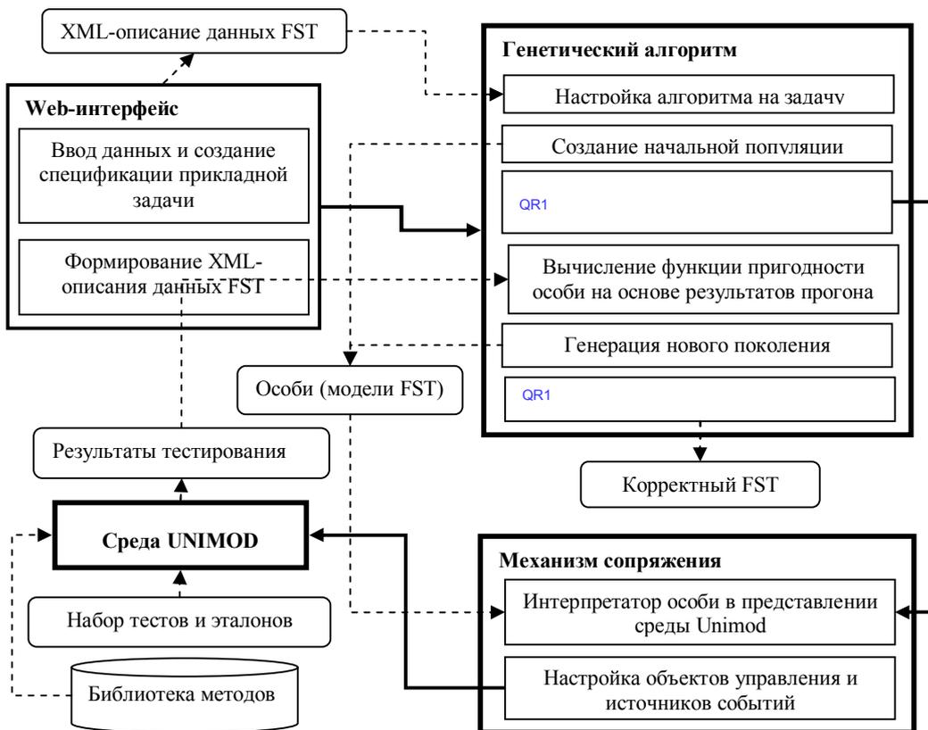
Рис.4. Обобщенная схема модели генератора.
