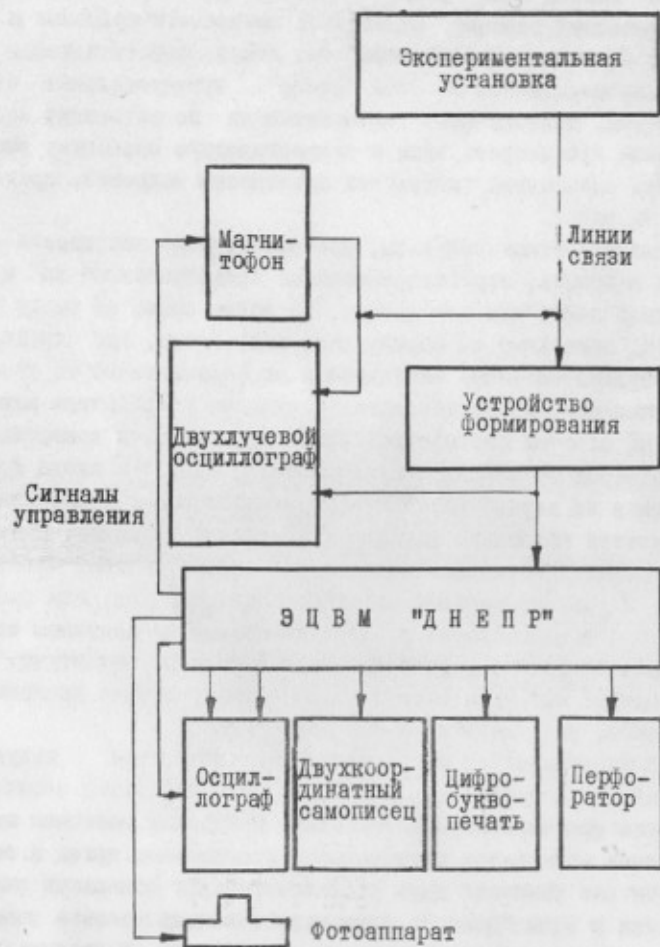
Рис.1. Функциональная схема комплекса для обработки импульсной активности нейронов.
